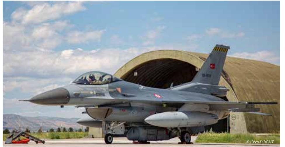
DB-110 keşif podu taşıyacak F-16C Block-30TM (Türk Modernizasyonu) uçakları 1'inci HİBM'nde modernize edilerek başta görev bilgisayarı olmak üzere üzerlerinde yer alan bazı aviyonikleri yenilenmiştir.
